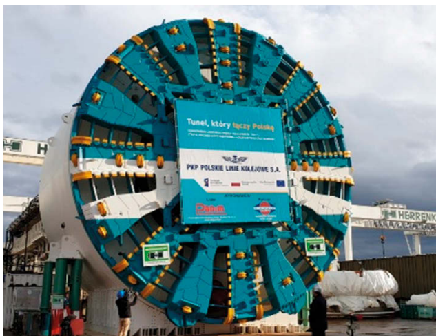
Rys. 2. TBM Katarzyna – na pierwszym planie jej głowica skrawająca [fot. studenci PW]
